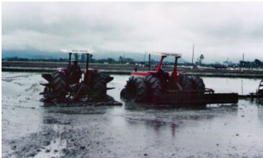
Figura 1 - Sistema de preparação do solo para plantio de arroz pré-germinado em solos de várzea, utilizando máquinas extremamente pesadas em solos inundados. Essa associação afeta negativamente a estrutura física do solo. Cortesia Prof. Silmar Peske.
