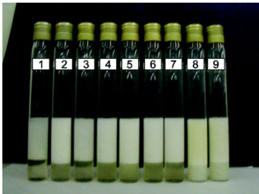
Figura 3. Atividade emulsificante ( E_{24} ) de solução de biosurfatante frente à diferentes hidrocarbonetos. (1) Hexano, (2) Tolueno, (3) Heptano, (4) Decano, (5) Querosene, (6) Tetradecano, (7) Hexadecano, (8) Óleo de soja, (9) Gordura de côco.
