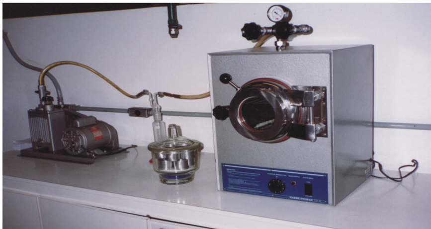
FIGURA 2 – ESTUFA A VÁCUO FABBE-PRIMAR FONTE: CANÇADO, 2001.
