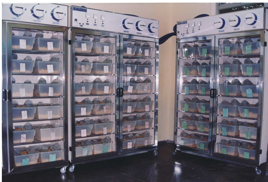
Figura 1: Estante ventilada para a manutenção de animais em condições sanitárias e de ambiente controladas
