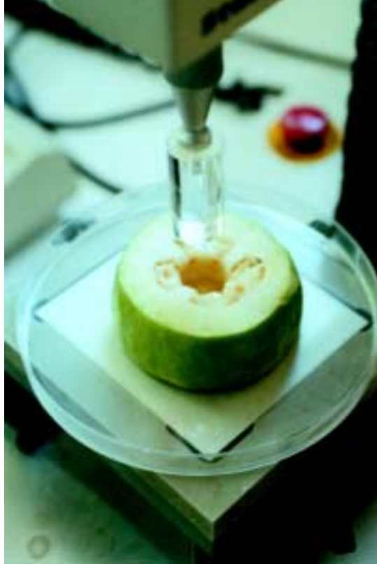
Figura 9 - A goiaba durante a análise no texturômetro
