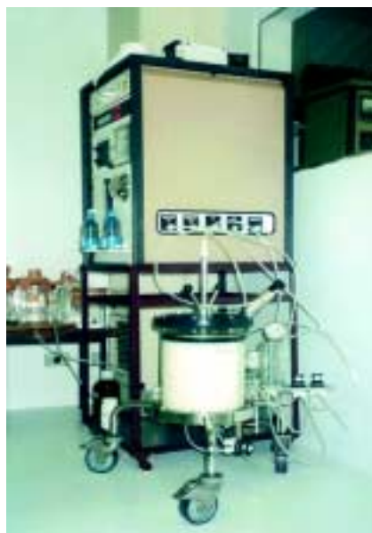
Fig 4. Coluna industrial com resina de troca iônica para o processamento de anticorpos monoclonais. Atrás, a torre de comando
