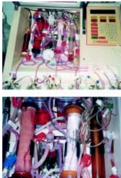
Fig 2. Biorreator de fibras ocas: acima, com todos os acessórios; abaixo, destacando os cartuchos de fibras ocas (esquerda) e de trocas gasosas (direita), após um mês de cultivo. Note a massa celular ao redor das fibras
