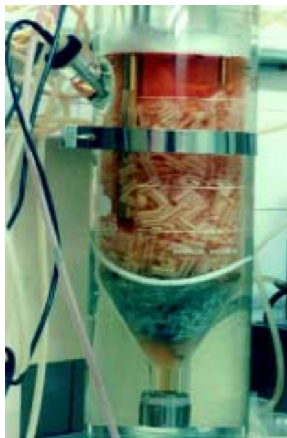
Fig 3. Dorna do biorreator “airlift” com configuração de leito empacotado. Cultivo em meio livre de soro aos 30 dias
