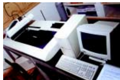
FIGURA 4: Equipamento Alizê (Analisador Automático de Bioquímica), capaz de realizar análises de concentrações de constituintes sanguíneos, aproximadamente 180 testes/hora
