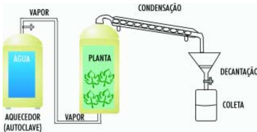
Figura 7 - Conjunto utilizado na extração de óleos essenciais por arraste a vapor
