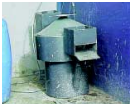
Figura 2: Biodigestor Piloto - Tipo Indiano - em funcionamento
