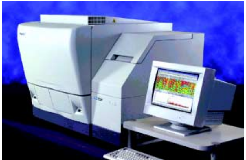
Sequenciador capilar de DNA - Megabace 1000 - Seis destes aparelhos são usados na geração de ESTs no HCGP
