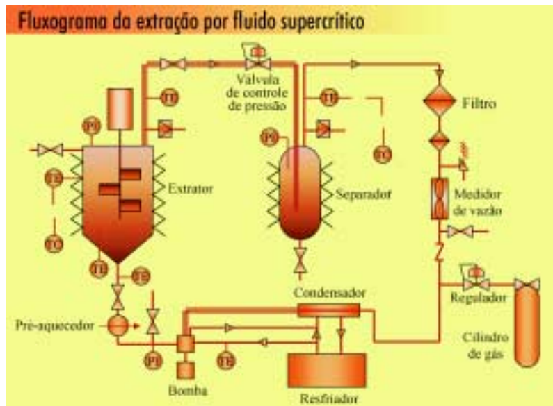
Figura 3: Fluxograma de extração supercrítica
