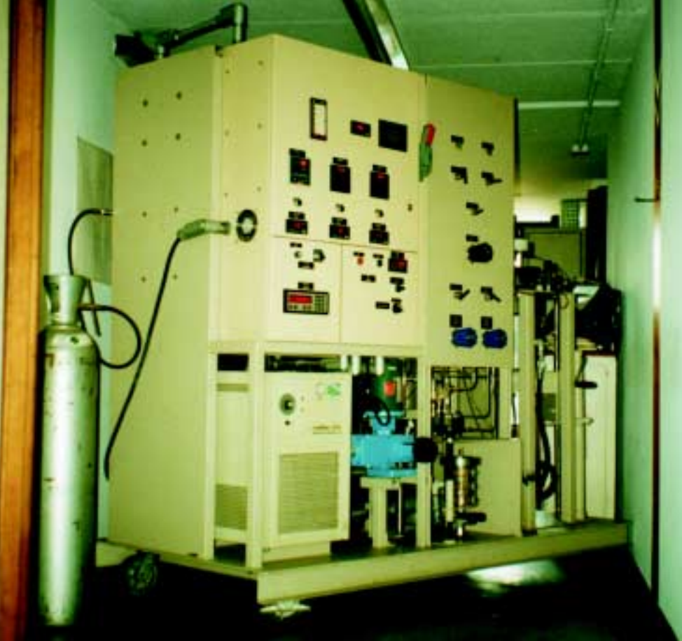
Figura 6: Aparelho de extração por fluido supercrítico ES-204
